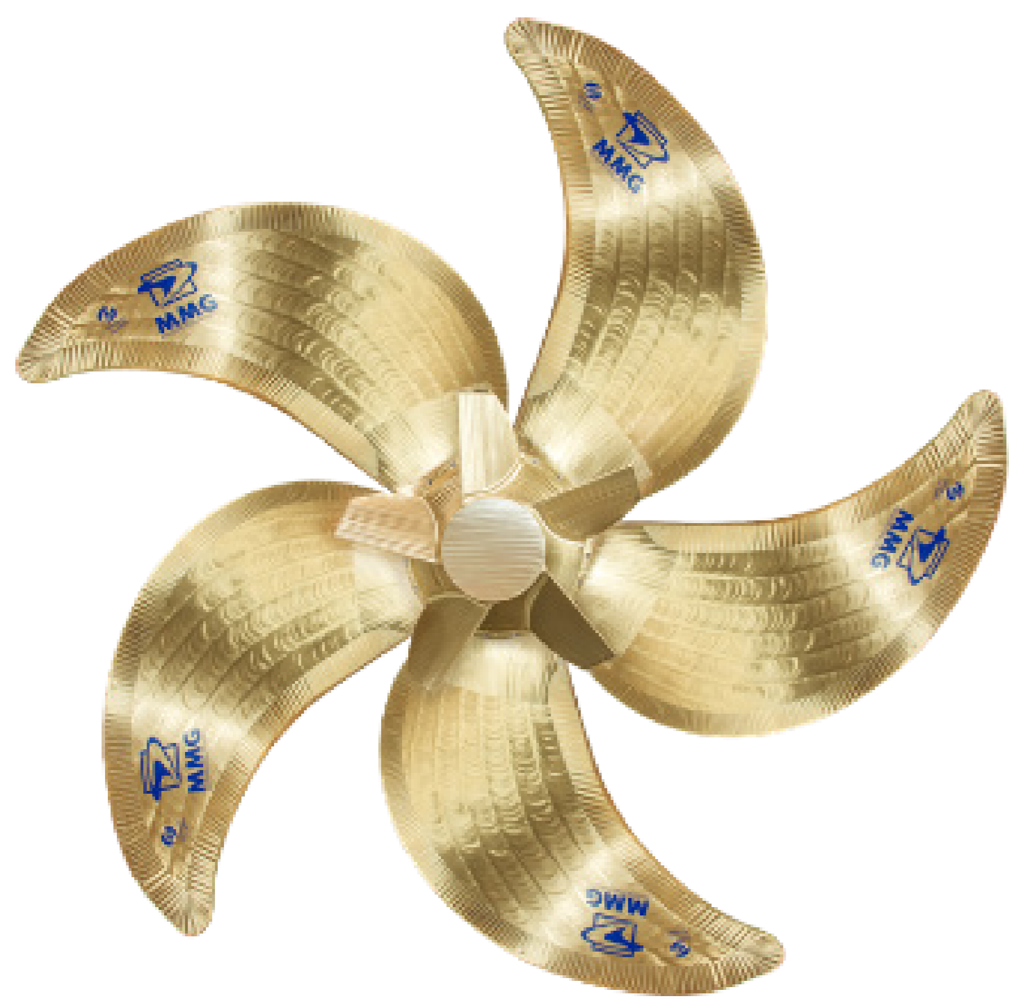
Schiffspropeller aus Kupferlegierung CuAl10Ni5Fe5 Durchmesser ca. 9 m [Mecklenburger Metallguss GmbH]
